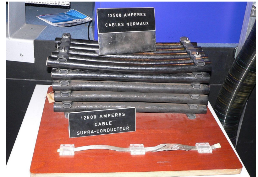
Câbles d'alimentation des expériences du CERN : en haut, les câbles du LEP ; en bas, les câbles du LHC, supraconducteurs
