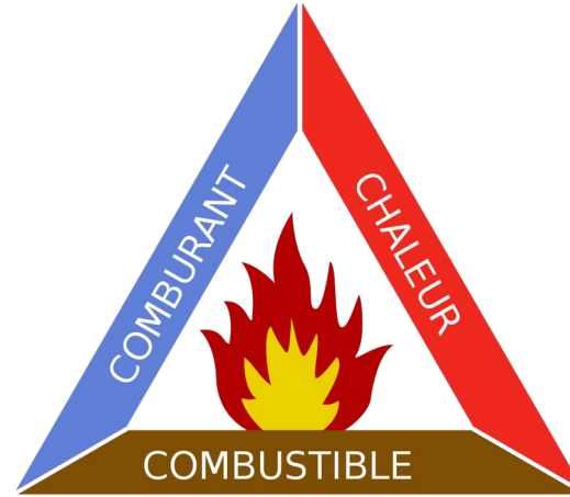
Éléments indispensables à une combustion
